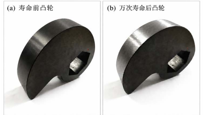
图 8 机械寿命试验前后凸轮工作表面形貌对比
